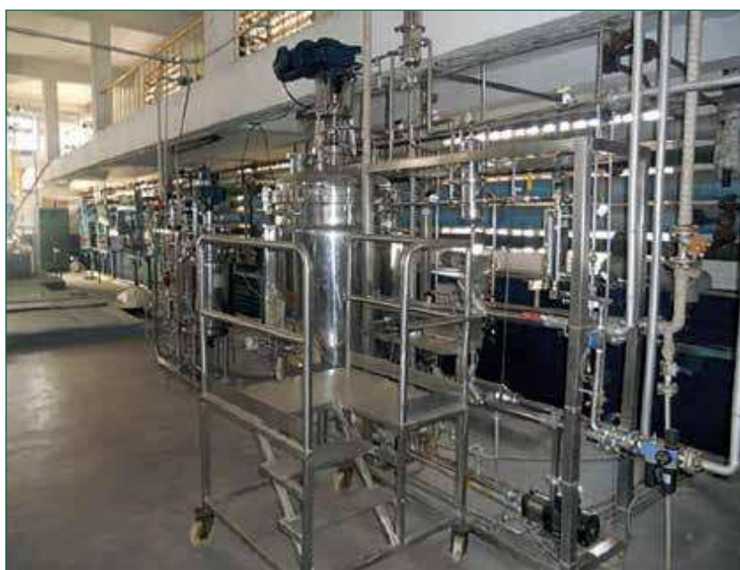
Figura 1 • Bioreattore Bioplus per la produzione di microalghe
